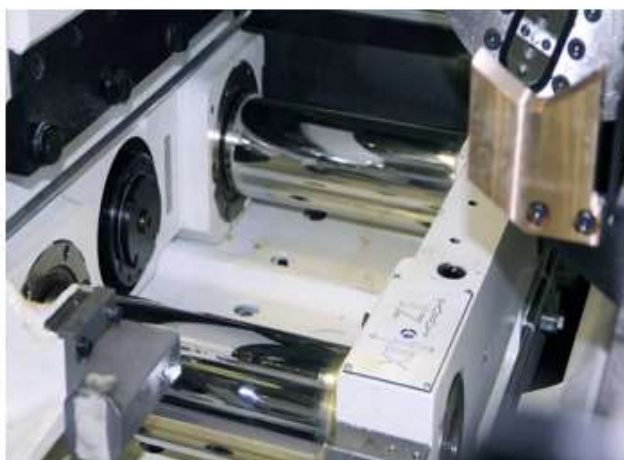
Figura 8 – Sistema de guias não hidrostáticas do Eixo X
